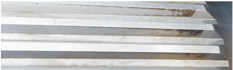
Bild 3: Kontaktdruckbereiche mit teilplastischen Zonen
