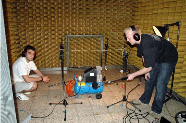
Bild 1: Zwei Studierende bei der Schallleistungsbestimmung eines kleinen Kompressors
