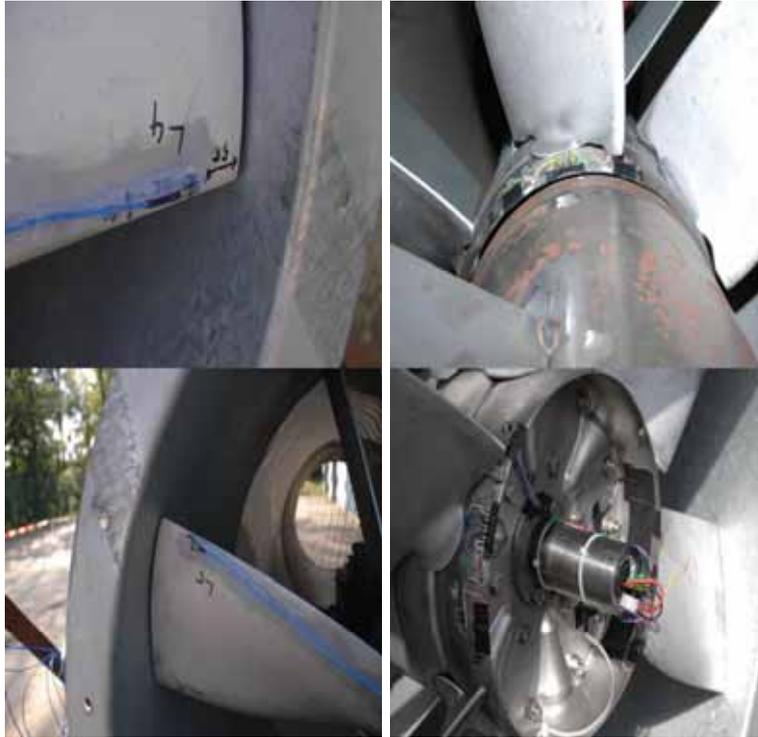
**Bild 3:** Sensorposition des einachsigen (L4) und dreiachsigen (L5) Beschleunigungsaufnehmer direkt auf der Schaufel (linke Spalte). DMS Position 1 und 2 sowie 3 und 4 auf der Halbschale zur Spannungsermittlung und Flansch zur Aufnahme des Telemetriesenders (rechte Spalte).
