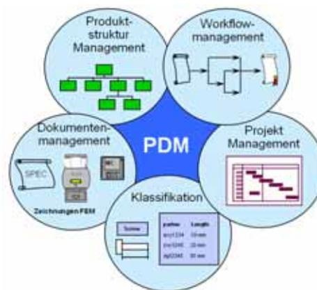
**Bild 2:** Die Funktionen eines PDM-Systems im Überblick
