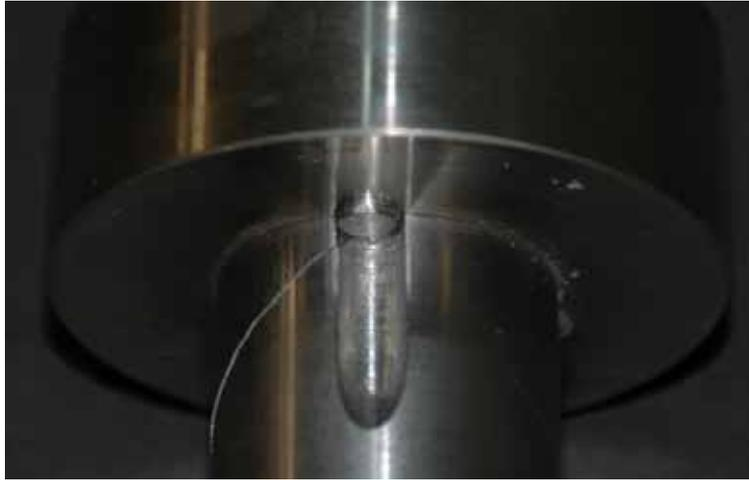
**Bild 5:** Torsionsbruch an Probe Geometrie 4
