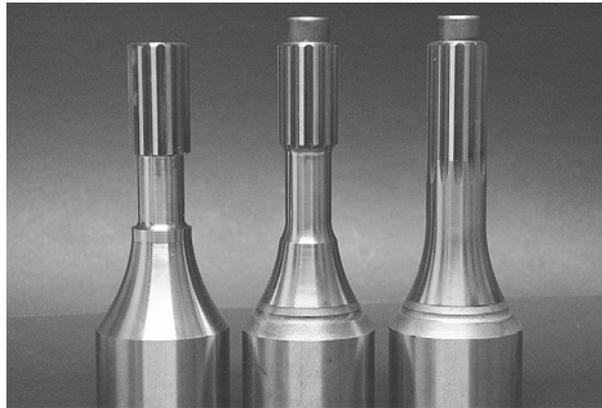
**Bild 3 und 4** zeigen in vergleichender Darstellung Prüflinge mit spanend (links) und umformend (rechts) gefertigter Verzahnung.
