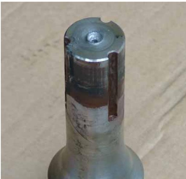
**Bild 8:** Längsstiftprobe nach Wechseltorsionsprüfung
