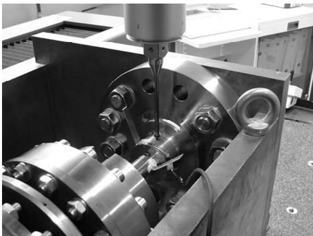
Bild 4: Messung an einer Passfederverbindung
