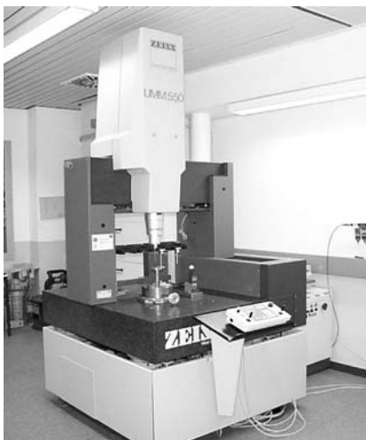
Bild 1: Koordinatenmessgerät des IMW
