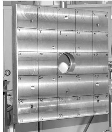
Bild 2: Markierungen definierter Messpunkte auf der Stahlplatte zur Vorbereitung der experimentellen Modalanalyse
